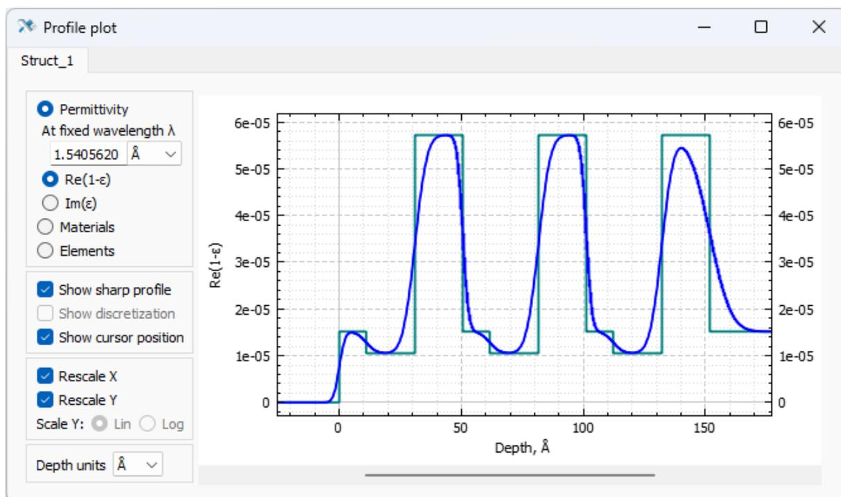
Рисунок 147. Профиль действительной части диэлектрической проницаемости
